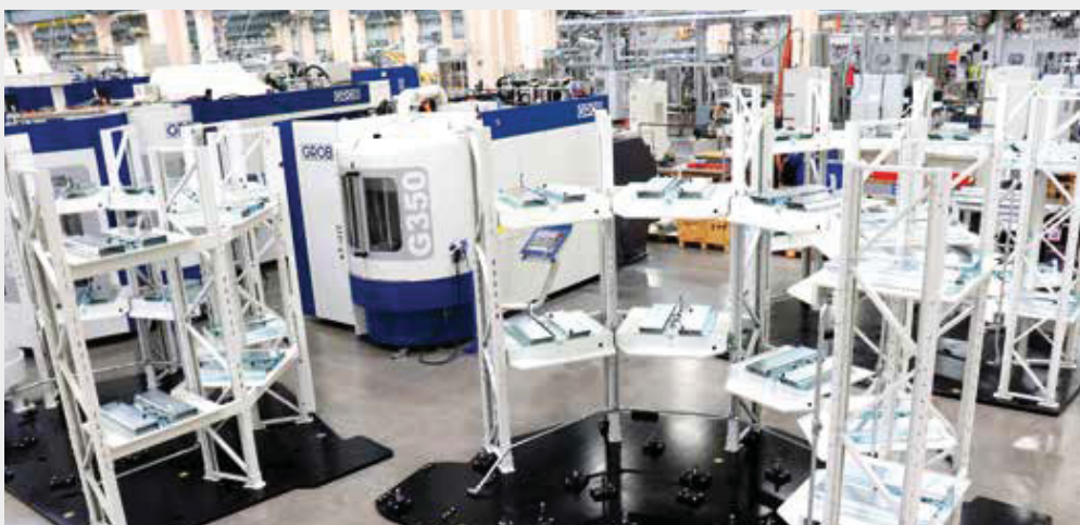
Baugruppenmontage für das Palettenrundspeichersystem PSS-R
