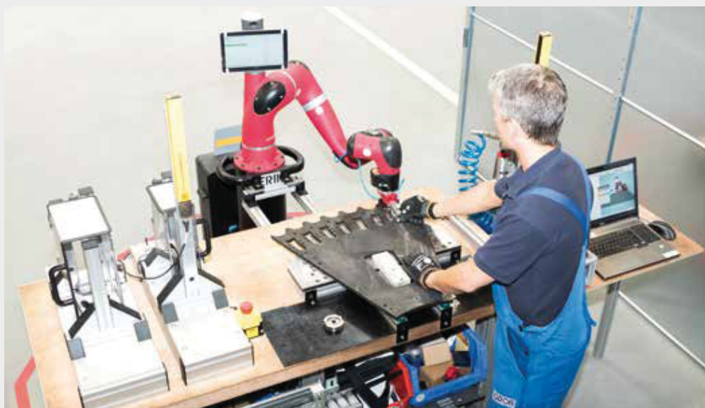
Kollaborierender Roboter zur Magazinklammer-Montage, Halle 6
