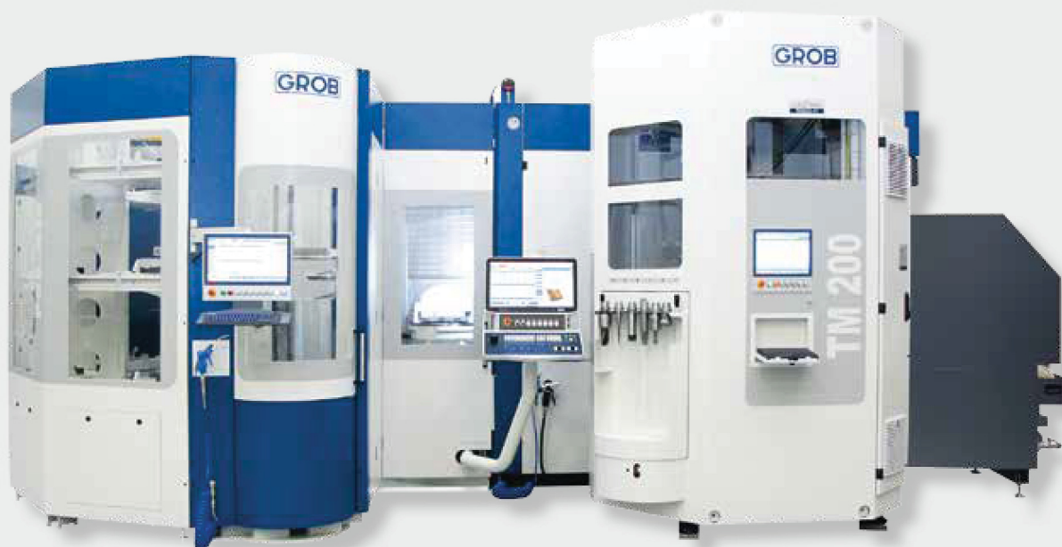
Automatisierung durch kombinierte Paletten- und Werkstückhandlings-Systeme
